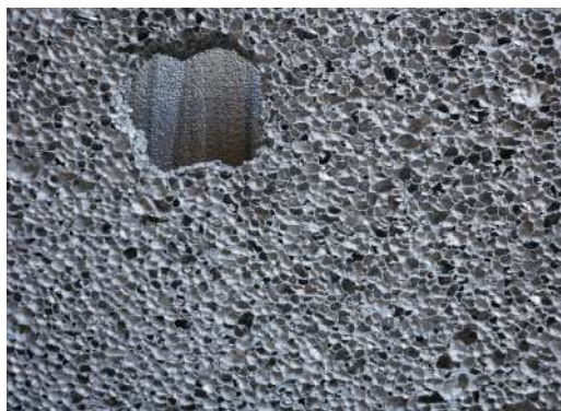
Abb. 51: Deckenplatte aus Aluminiumschaum und Systemdecke aus Aluminiumschaumplatten
